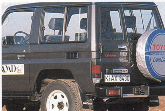
Die Scheibenrahmen der Schiebefenster und Hecktüren liebt der Rost
