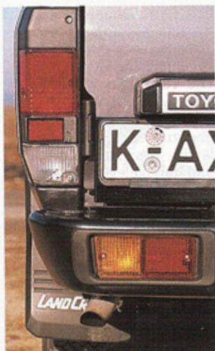
Im Spritzbereich der Räder liegende Rückleuchten fallen oft aus
