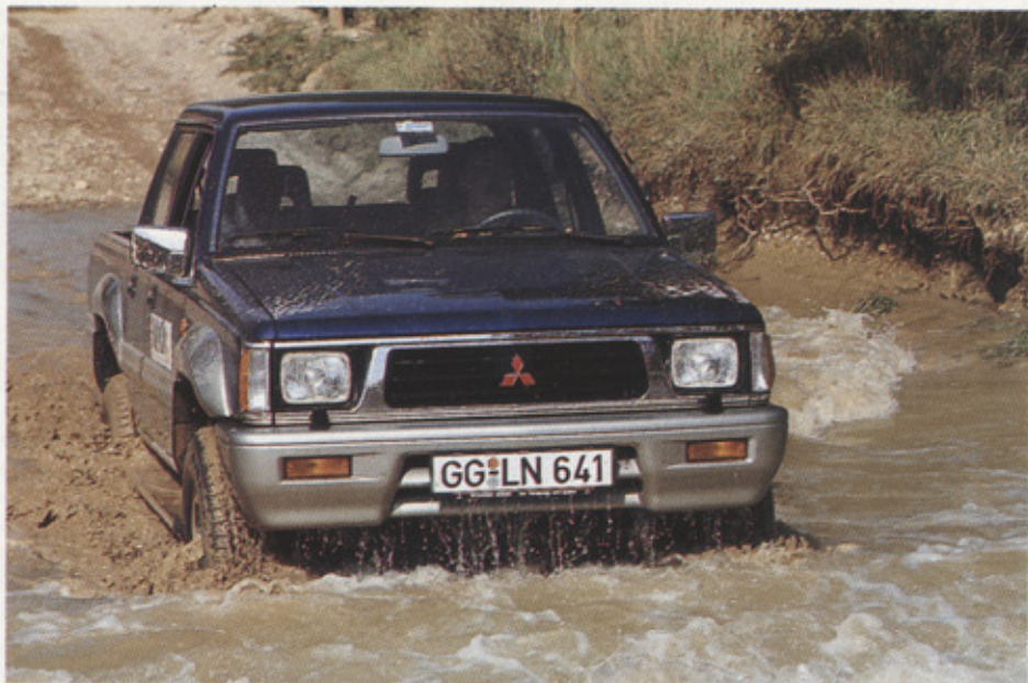
Keine Angst vorm nassen Element hat der L 200, sein Motor saugt die Luft in einem Meter Höhe an
