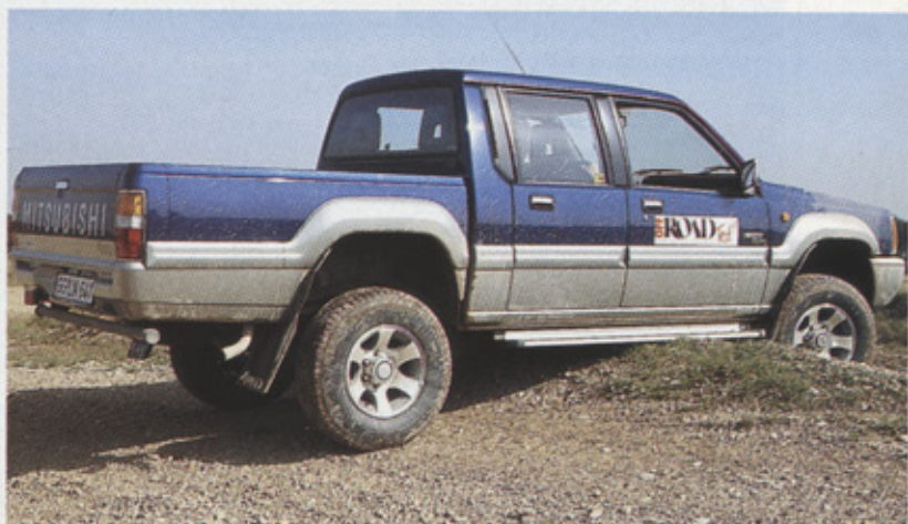
Der lange Radstand läßt den L 200 an Kuppen leicht aufsitzen
