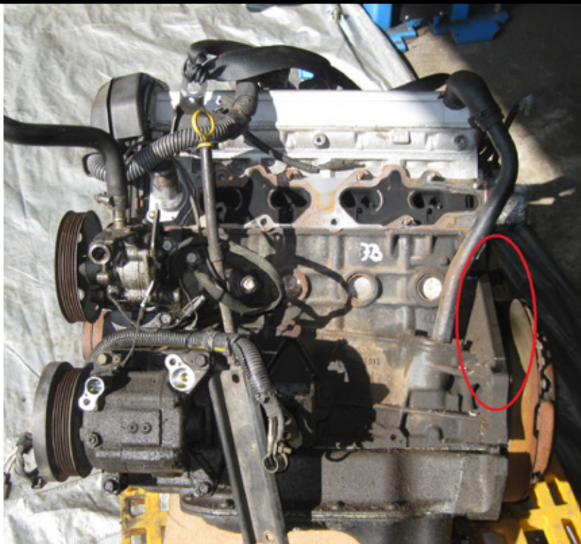
Wer die Motornummer sucht, wird an der markierten Stelle fündig. Sie gibt genau Auskunft darüber, welcher Motortyp verbaut ist.
