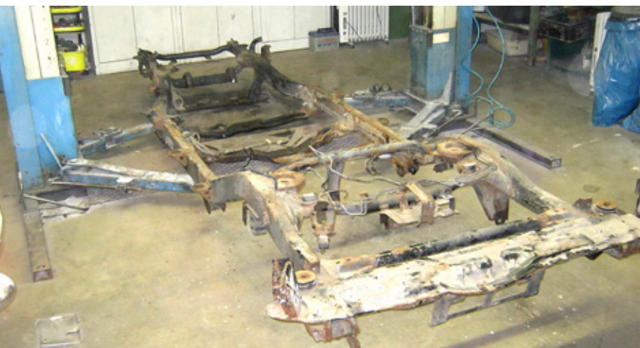
Alle Fronteras bauen noch klassisch auf einen Leiterrahmen.
